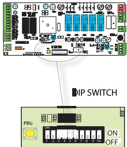
**ВНИМАНИЕ!** При отсутствии электрических подключений к контактам 1-2 и 2-C5 микропереключатели № 9 и 8 должны быть установлены в положение ON.
